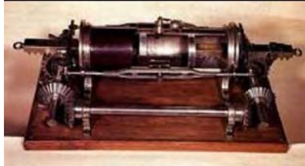
Motore di Bersanti e Mattiucci del 1858 a stantuffi contrapposti
