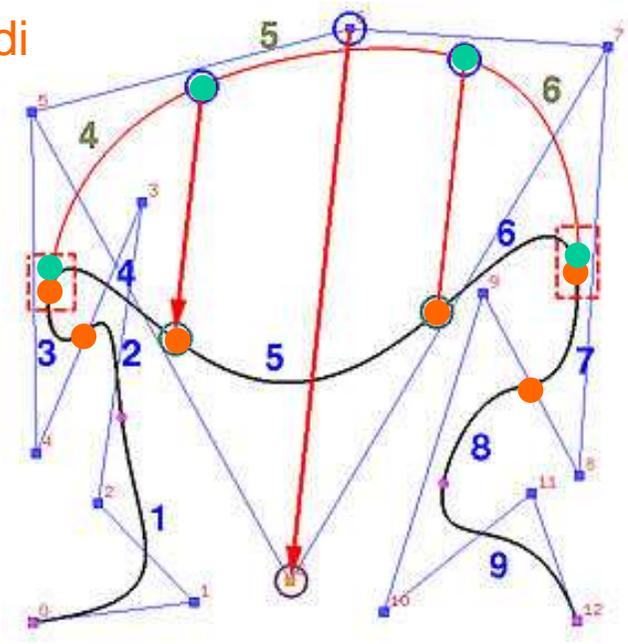
Muovendo  $P_6$  si modificano solo i segmenti di arco 3, 4, 5, 6 e 7 che vanno da  $P(u_6)$  a  $P(u_{11})$ .
